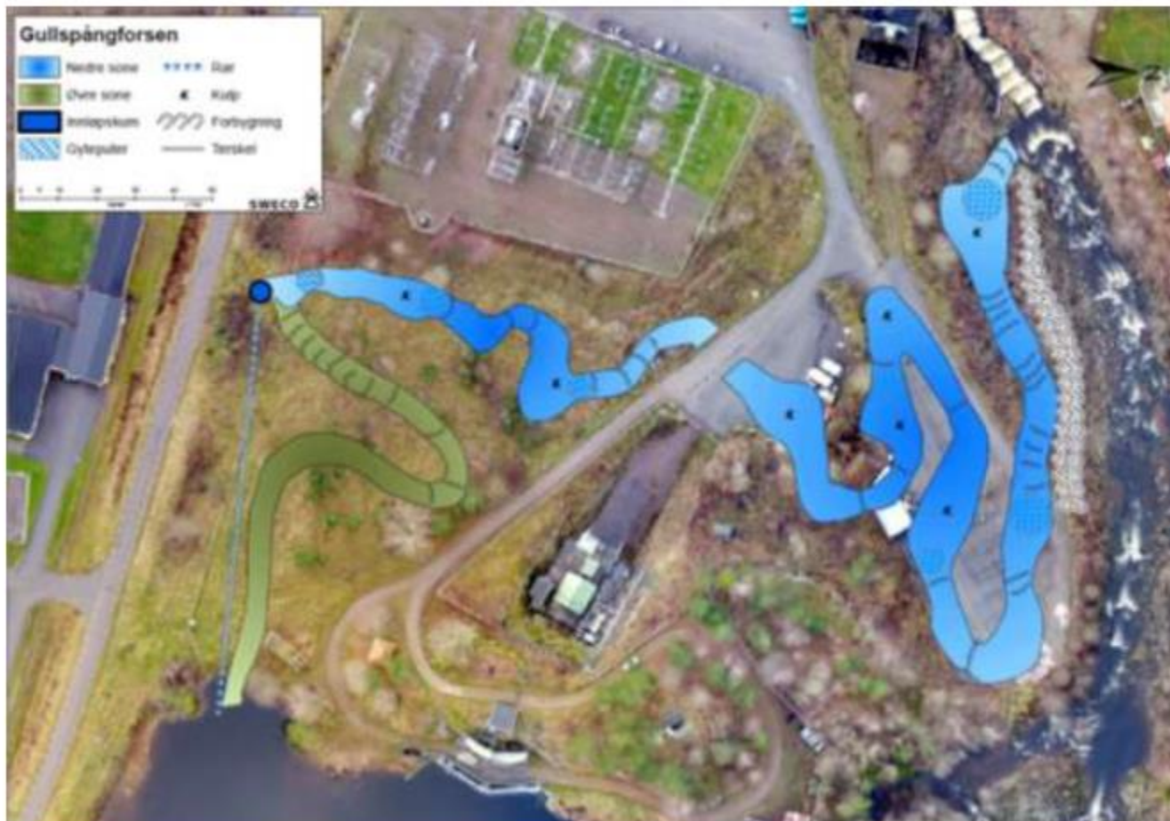
Figur 39. Konceptuellt förslag till utformning av en lekkanal ("Spawning channel"). Förslaget är utformat utifrån områdets topografiska förhållanden.
